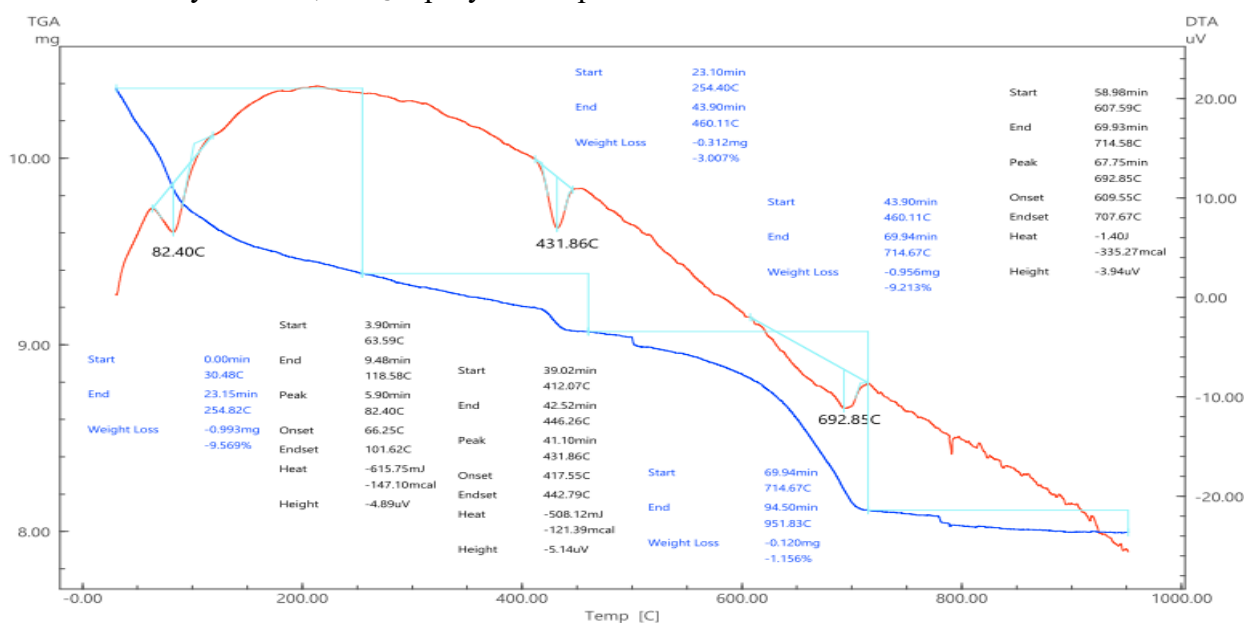
Рисунок 4 - ТГА – термогравиметрическая кривая газобетона с добавкой 7 % АЦО; ДСК – кривая дифференциальной сканирующей калориметрии
